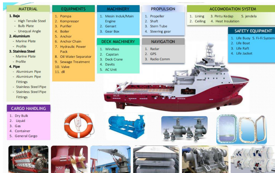
Gambar 4- 36. Komponen utama sebuah kapal, salah satunya adalah sistem propulsi (PIKKI, 2017)
