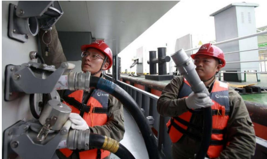
Gambar 2- 5. Sistem Charging pada Kapal Fully Electric
